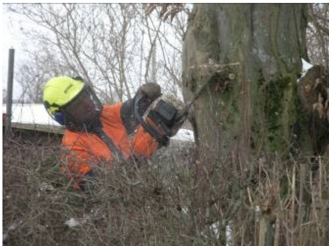
Anbringen einer sauberen geradlinigen Fällkerbe
